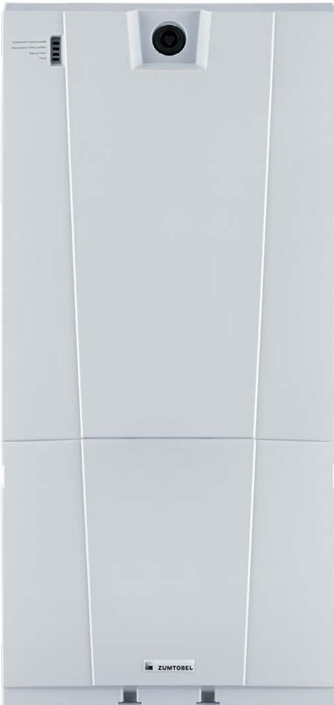
Die eBox ist ein für die effiziente LED-Technologie optimiertes Zentralbatteriesystem. Der Energieverbrauch sowie die Anzahl der notwendigen Batterien wurden auf ein Minimum reduziert. Durch den modularen Aufbau erhöht sich die Anzahl der möglichen Ausgangskreise, und das System erreicht eine maximale Flexibilität, um so die Versorgung optimal an die Anforderungen jedes Gebäudes anzupassen.
